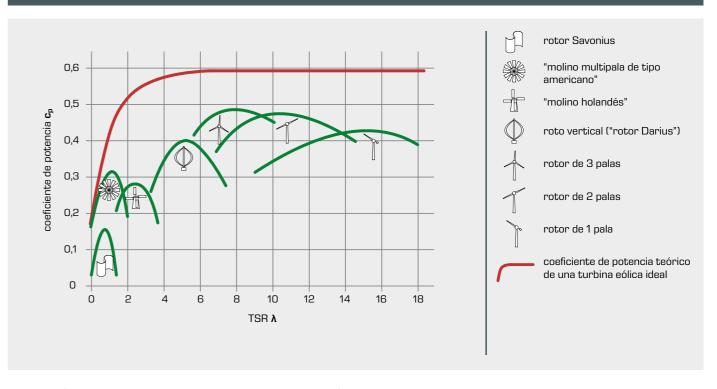
Cuanto más alta sea la TSR, mejor debe ser el perfil aerodinámico de la pala del rotor. De lo contrario, las fuerzas de resistencia vuelven a agotar los posibles coeficientes de potencia altos. El rotor de 3 palas se considera el modelo óptimo, también
