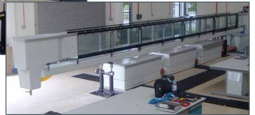
Diese fertig montierte Versuchsrinne steht an der Universiti Teknologi Petronas (UTP) in Ipoh, Malaysia.
