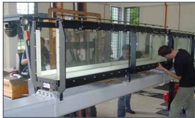
Das Element der Versuchsstrecke wird mit einem Gabelstapler etc. auf den Hilfsträger gesetzt, ausgerichtet und montiert.
