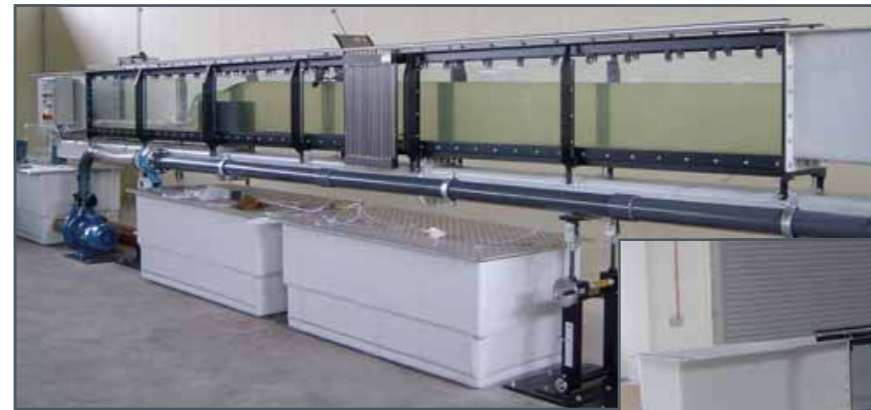
Nach der abgeschlossenen Montage erfolgt die Inbetriebnahme, hier mit breitkronigem Wehr.
