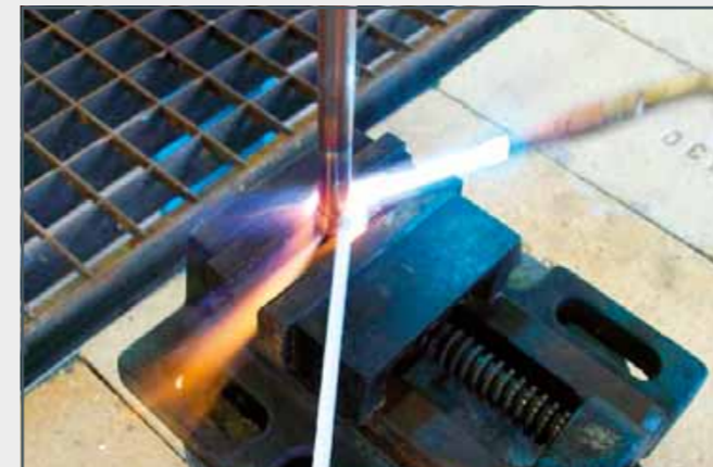
Erwärmen der Werkstücke bis zur Löthitze und Abschmelzen von Flussmittel und Lot. Lot füllt durch Kapillarwirkung den Lötspalt selbstständig aus.
