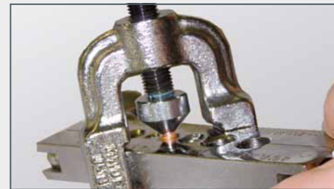
Bördeln des Rohres mit dem Bördelwerkzeug
