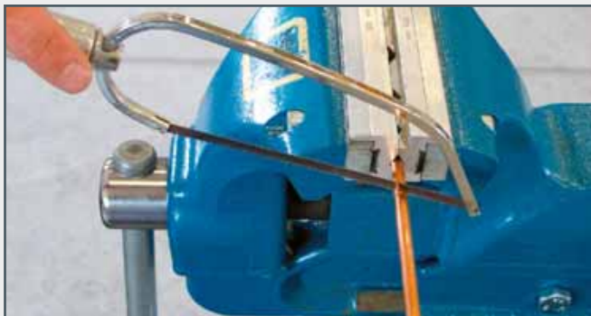
Länge des Rohrabschnittes bestimmen. Hierbei Zuschläge für Biegungen und Bördel berücksichtigen. Absägen des Rohres.
