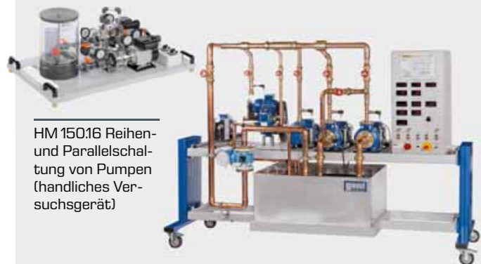
HM 362 Vergleich von Pumpen (komplexer Versuchstand)
