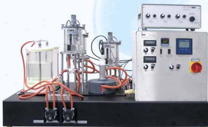
Unidad de Alimentación para los Reactores Químicos CE 310 con los Reactores Continuos de Mezcla Perfecta en Serie CE 310.03
