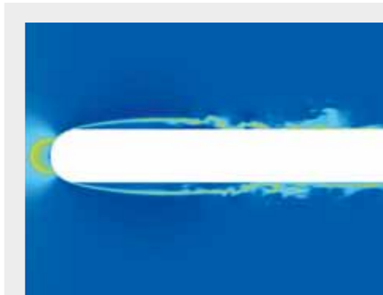
Capa límite y separación en una placa
