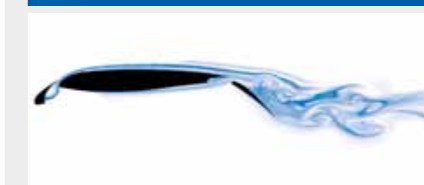
Capa límite y separación en una superficie sustentadora y alerones
