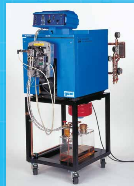
HL 351 Sistema de Demostración Caldera de Calefacción
