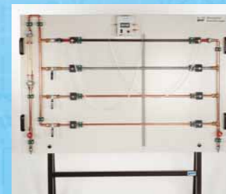
HL 102 Panel de Prácticas de Pérdidas de Carga en Tuberías
