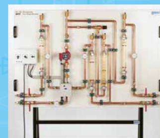
HL 106 Panel de Prácticas con Válvula Mezcladora de 4 Vías
