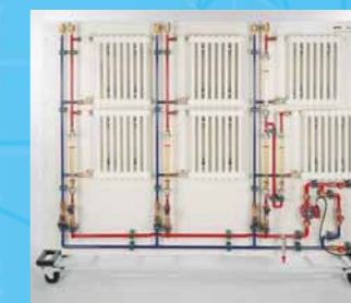
HL 305 Banco de Prácticas para Compensación Hidráulica de Radiadores
