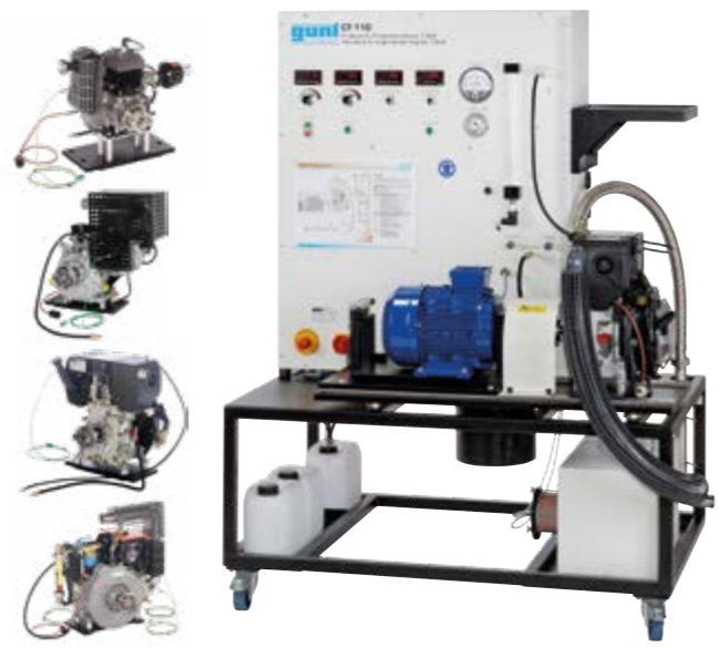
CT 110 Banc d'essai pour moteurs monocylindres, 7,5 kW
