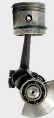
Fuerzas de inercia oscilantes y rotatorias en un émbolo de elevación
