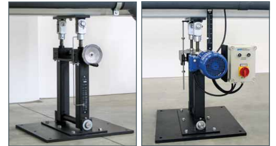
Ajuste de la inclinación en el HM 162 y el HM 163: izquierda ajuste de la inclinación manual, derecha ajuste de la inclinación eléctrico HM 162.57/HM163.57
