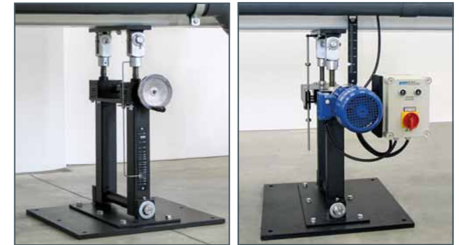
Neigungsverstellung bei HM 162 und HM 163: links manuelle Neigungsverstellung, rechts elektrische Neigungsverstellung HM 162.57 / HM 163.57
