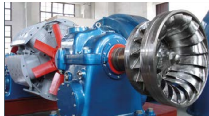
Turbina Francis desmontada
