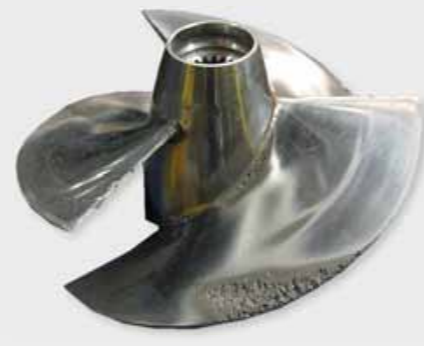
Hélice de bateau détruite par l'érosion de cavitation
