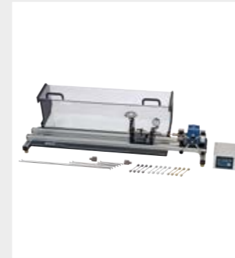
El equipo de ensayo compacto WP 500 genera momentos de ensayo de 30 Nm
