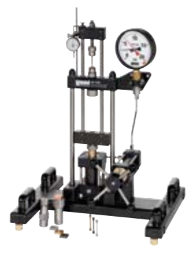
El equipo de ensayo compacto WP 300 genera una fuerza de ensayo de 20 kN
