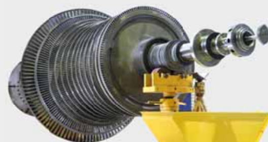
Roue d'une turbine à vapeur à l'état démonté
