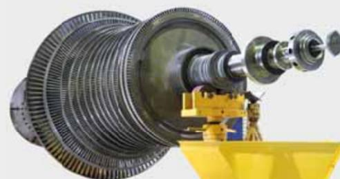
Rodete de una turbina de vapor en estado desmontado
