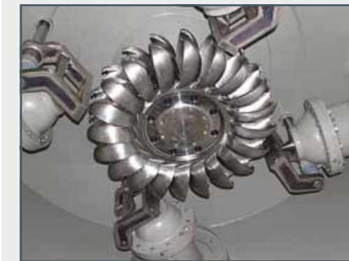
Rotor con cucharas dobles a modo de álabes móviles y toberas de aguja
