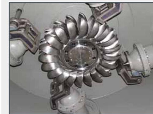
Laufrad mit Doppelbechern als Laufschaufeln und Nadeldüsen
