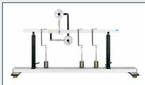
WP 960 Poutre sur 2 supports: courbes des efforts tranchants et des moments de flexion
