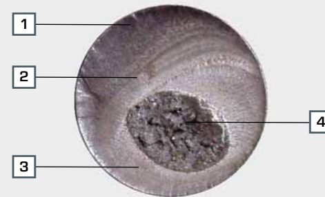
Beurteilung der Bruchfläche nach dem Dauerfestigkeitsversuch
