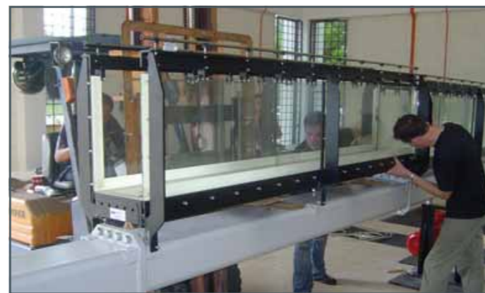
L'élément de la section d'essai est placé sur le support auxiliaire à l'aide d'un chariot élévateur à fourche, aligné puis monté.
