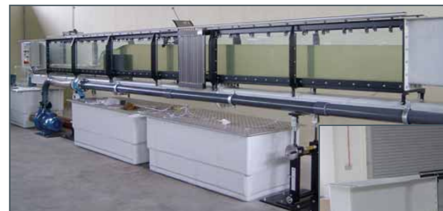
Une fois le montage terminé, la mise en service a lieu, ici avec un déversoir à seuil épais.
