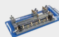
HM 250.10 Évolution de la pression le long de la section d'entrée
