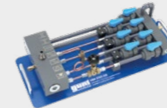
HM 250.08 Pérdidas en elementos de tuberías
