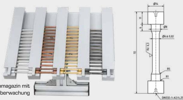
Probenmagazin mit Füllstandsüberwachung
