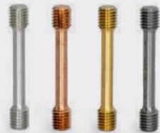
Zugproben mit kreisförmigem Querschnitt gemäß DIN 50125, Werkstoff: Al, Cu, St, CuZn
