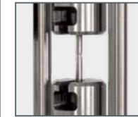
Eine normgerechte metallische Zugprobe wird unter Normbedingungen „zerrissen“
