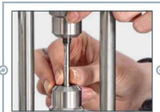
Zugprobe in Werkstoffprüfgerät einspannen
