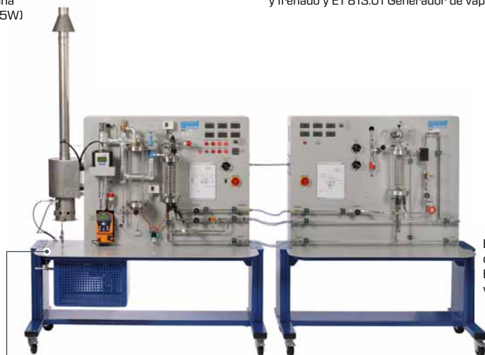
ET 813 Máquina de vapor de dos cilindros (500W) con HM 365 Unidad universal de accionamiento y frenado y ET 813.01 Generador de vapor eléctrico
