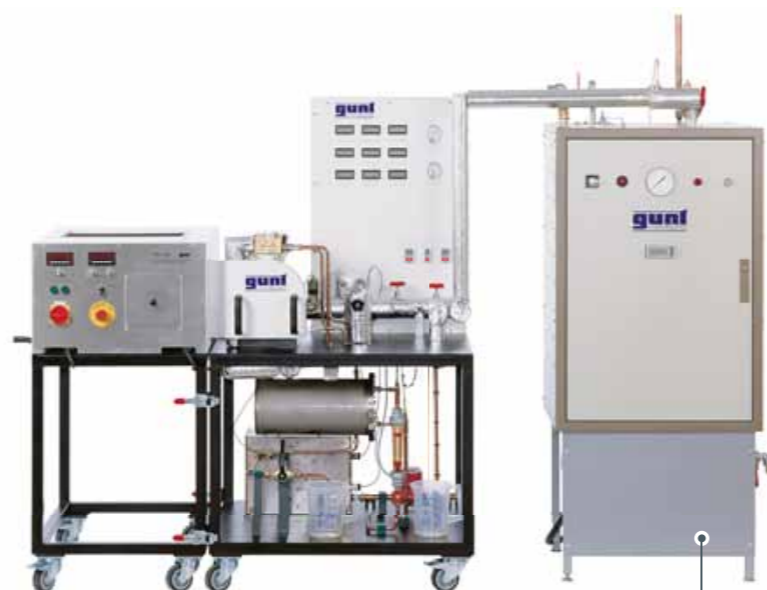
ET 813 Máquina de vapor de dos cilindros (500W) con HM 365 Unidad universal de accionamiento y frenado y ET 813.01 Generador de vapor eléctrico
