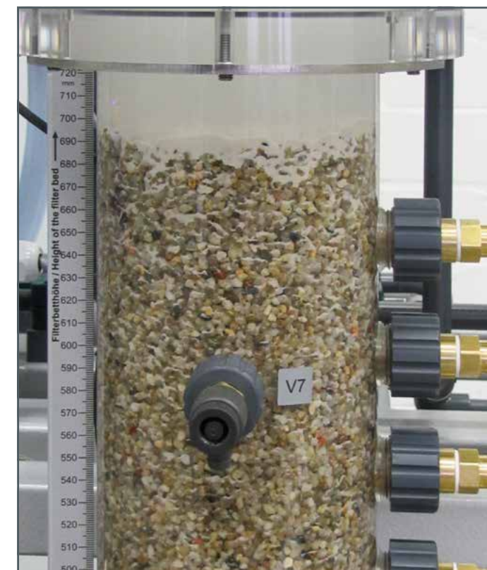
Tube filtrant transparent pour observer le chargement progressif du lit filtrant
