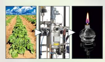
Der Gärprozess ist dann abgeschlossen, wenn entweder der Zucker verbraucht oder eine maximale Alkoholkonzentration erreicht ist. Das entstehende Bioethanol wird durch Destillation abgetrennt. Das Produkt der Destillation wird als Rohalkohol bezeichnet.
