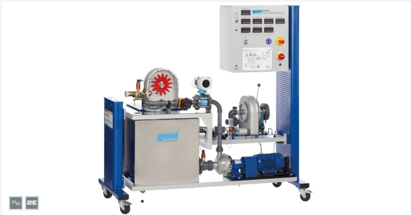
L'illustration montre le HM 450C avec les turbines HM 450.01 (à gauche) et HM 450.02 (à droite).
