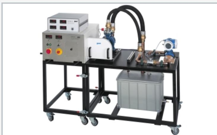
Montage expérimental fonctionnel: unité d'entraînement HM 365 (à gauche), HM 365.10 avec pompe à étudier (à droite)
