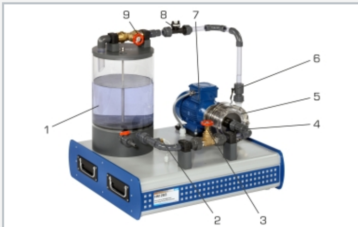
1 Wasserbehälter, 2 Temperaturenfnehmer, 3 Ventil am Eintritt, 4 Druckaufnehmer am Eintritt, 5 Pumpe, 6 Druckaufnehmer am Austritt, 7 Motor, 8 Durchflussaufnehmer, 9 Ventil am Austritt
