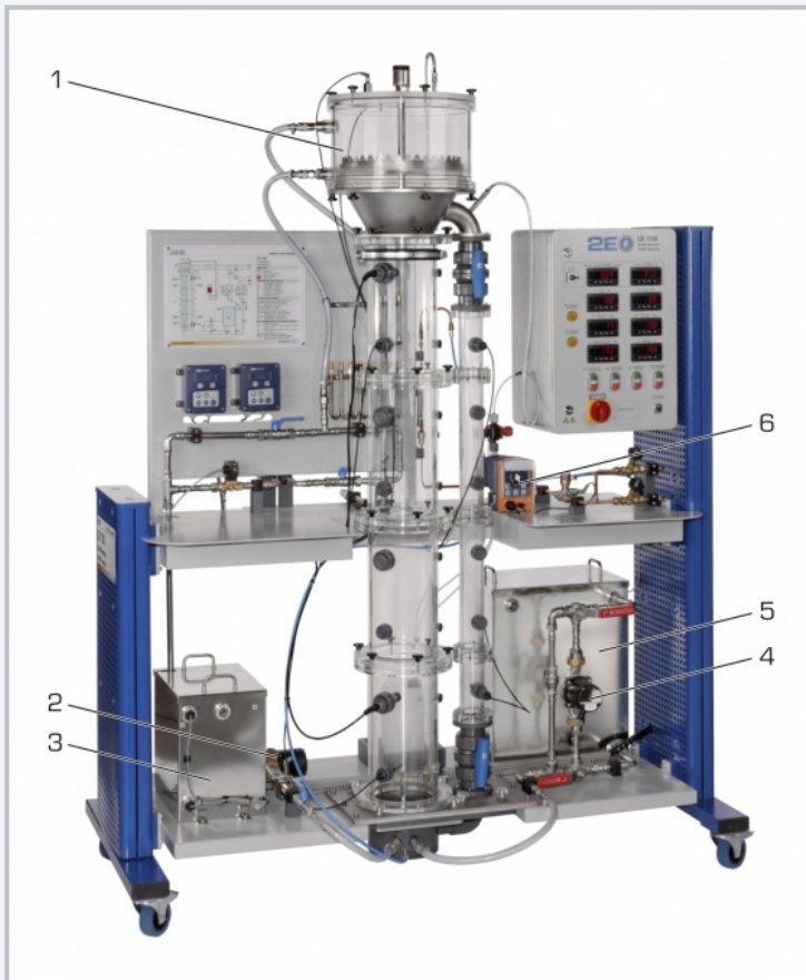
1 Airlift-Reaktor mit externem Umlauf, 2 Zulaufpumpe, 3 Zulaufbehälter, 4 Umwälzpumpe, 5 Speicherbehälter, 6 Dosierpumpe
