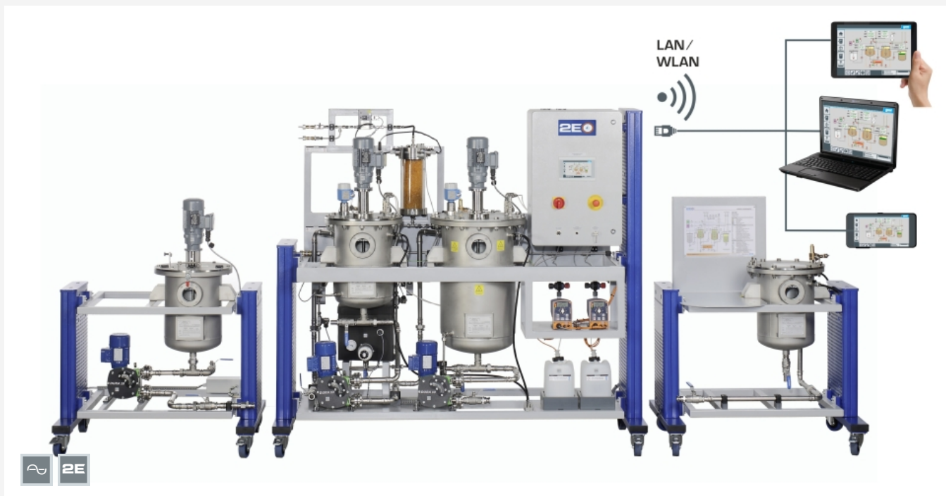
Die Abbildung zeigt von links: Versorgungseinheit, Versuchsstand und Nachgärungseinheit; Screen-Mirroring ist an verschiedenen Endgeräten möglich
