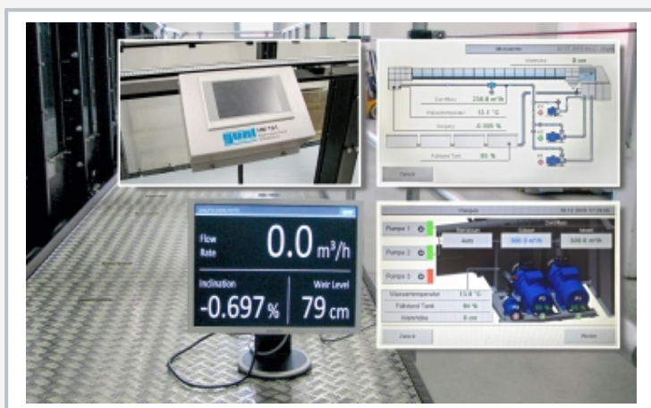
Écran avec affichage des valeurs de mesure et des états de fonctionnement, écran tactile librement positionnable (à gauche) et captures d'écran de l'API (à droite)
