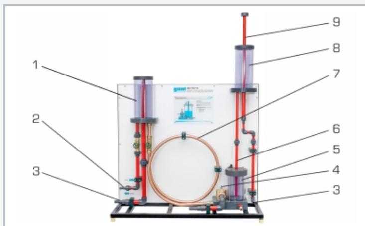
1 réservoir d'alimentation avec trop-plein fixe, 2 raccord d'eau, 3 évacuation de l'eau, 4 vanne d'impulsion avec levée, 5 réservoir d'air avec clapet de retenue, 6 conduite montante, 7 tuyau, 8 réservoir élevé, 9 trop-plein ajustable
