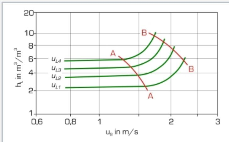
Diagramme holdup: A point de charge, B point d'engorgement,  $h_L$  holdup,  $u_g$  vitesse de gaz dans le tube vide,  $u_{L1-4}$  charge de liquide spécifique
