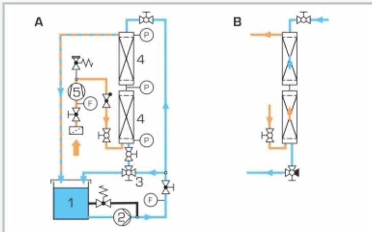
A schéma de processus: 1 réservoir de stockage, 2 pompe, 3 robinet inverseur, 4 colonne à garnissage, 5 compresseur; F débit, P pression; B mode de fonctionnement descendant à l'eau, ascendant à l'air (contre-courant)
