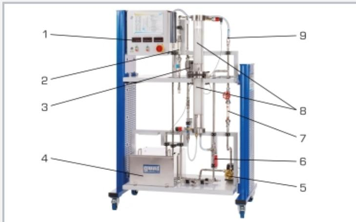
1 affichages numériques de la pression, 2 débitmètre d'air, 3 compresseur d'air, 4 réservoir de stockage, 5 pompe à eau, 6 robinet inverseur inférieur ascendant/descendant, 7 débitmètre d'eau, 8 colonne à garnissage à deux parties, 9 robinet inverseur supérieur ascendant/descendant
