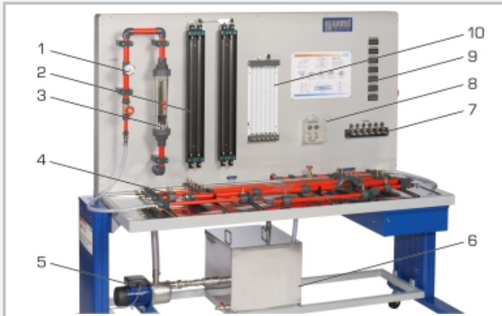
1 Thermometer, 2 2-Rohrmanometer, 3 Schwebekörper-Durchflussmesser, 4 verschiedene Rohrstrecken, 5 Pumpe, 6 Vorratsbehälter, 7 Druckaufnehmer, 8 Differenzdruckmessgerät, 9 digitale Druckanzeigen, 10 6-Rohrmanometer
