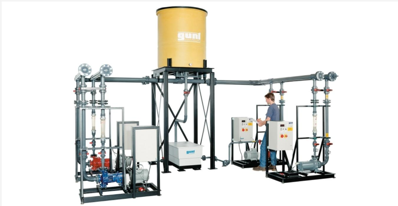
La ilustración muestra la estructura completa de un sistema de bombas formado por cuatro bancos de pruebas HL 962 con una bomba (HL 962.01 – HL 962.04) cada uno, el sistema de tuberías HL 962.32 y el sistema de depósito HL 962.30.
