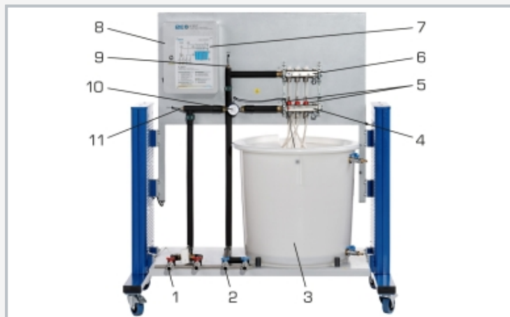
1 Anschluss für Vorlauf, 2 Anschluss für Rücklauf, 3 Behälter für Kalt- / Warmwasser, 4 Verteiler Vorlauf, 5 Durchflussmesser, 6 Verteiler Rücklauf, 7 Infotafel, 8 Anschlusskasten für Messaufnehmer, 9 Temperaturlaufnehmer Rücklauf, 10 Durchflussmesser, 11 Temperaturlaufnehmer Rücklauf
