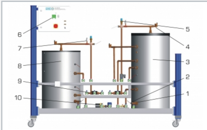
1 Frischwasserzulauf, 2 Temperaturnahnehmer, 3 bivalenter Speicher, 4 Entlüftungsventil, 5 Überdruckventil, 6 frei programmierbarer Universalregler, 7 Druckaufnehmer, 8 Pufferspeicher, 9 drehzahlgeregelte Pumpe, 10 angetriebenes Dreiwegeventil
