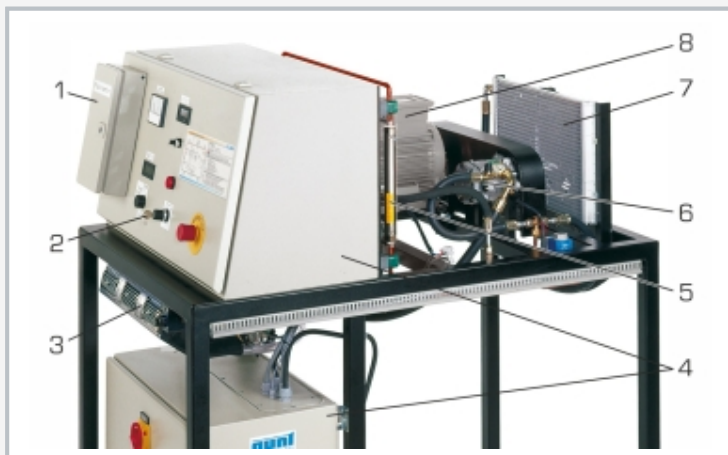
1 boîte avec des boutons de pannes, 2 interrupteur d'allumage, 3 refroidisseur d'air avec ventilateur à trois niveaux, 4 armoire de commande, 5 débitmètre, 6 compresseur, 7 condenseur avec ventilateur, 8 moteur électrique
