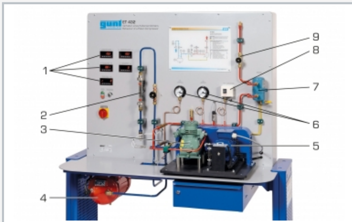
1 Anzeige- und Bedienelemente, 2 Durchflussmesser, 3 Kältemittelverdichter, 4 Beruhigungsbehälter, 5 Antriebsmotor mit Drehmomentmessung, 6 Manometer, 7 Ölabscheider, 8 Druckschalter, 9 Ventil
