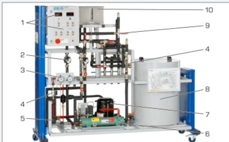
1 éléments d'affichage et de commande, 2 pompe, 3 manomètre, 4 débitmètre, 5 évaporateur, 6 condenseur, 7 compresseur, 8 accumulateur de glace, 9 soupape à 3 voies, 10 réservoir de compensation
