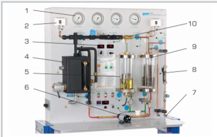
1 Manometer, 2 Druckschalter, 3 Anzeige- und Bedienelemente, 4 Dampferzeuger, 5 Verdampfer, 6 Pumpe, 7 Anschlüsse für Kühlwasser, 8 Durchflussmesser, 9 Verflüssiger, 10 Dampfstrahlverdichter
