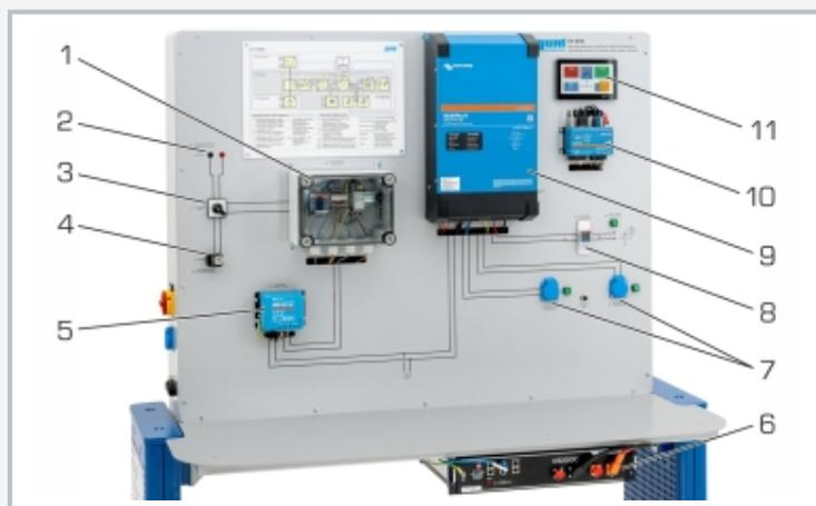
1 Gleichstrom-Trennschalter mit Überspannungsschutz, 2 Anschluss Photovoltaiksimulator, 3 Umschalter zwischen Photovoltaiksimulator / Photovoltaikmodulen, 4 Anschluss Photovoltaikmodule, 5 MPP-Laderegler, 6 LiFePO Akkumulator, 7 Steckdosen für Wechselstromverbraucher, 8 Zweirichtungsstromzähler, 9 Netzwechselrichter, 10 Steuereinheit, 11 Touchscreen
