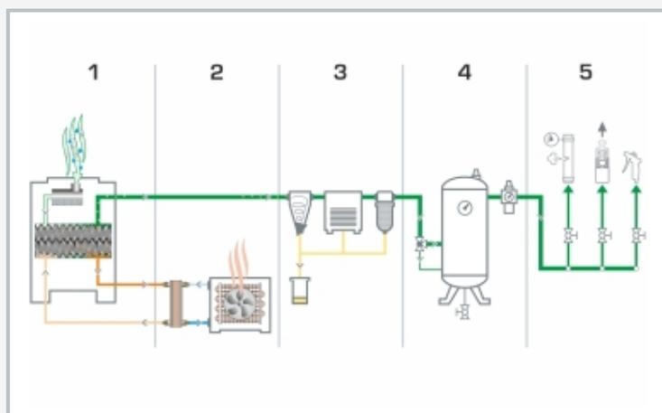
Modules fonctionnels de l'installation d'air comprimé: 1 génération d'air comprimé, 2 récupération de la chaleur, 3 préparation de l'air comprimé (séparateur à cyclone, sécheur frigorifique, filtre), 4 stockage avec groupe de sécurité et unité de préparation d'air, 5 consommateurs continus et occasionnels; vert: air comprimé, orange: huile, bleu: eau, jaune: condensat avec huile
