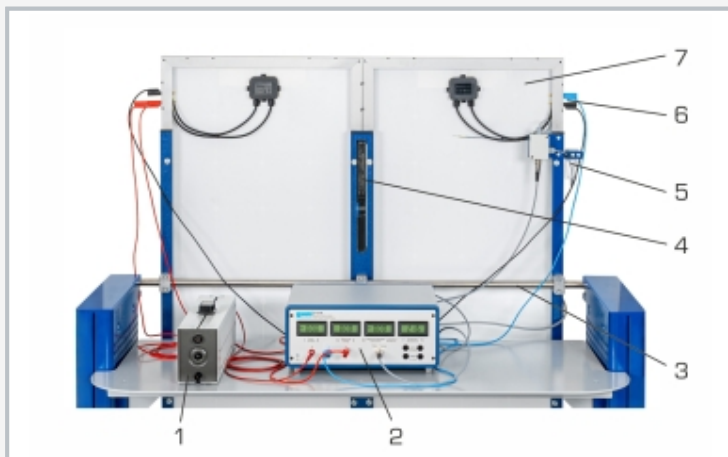
1 reóstato de cursor, 2 amplificador de medida, 3 eje basculante para el ajuste de la inclinación, 4 medidor de inclinación, 5 sensor de iluminancia, 6 sensor de temperatura, 7 módulos fotovoltaicos
