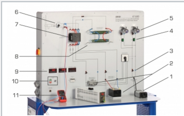
1 Wechselschalter, 2 Akkumulatoren, 3 Messpunkt Strom und Spannung, 4 Schalter für elektrische Last, 5 Lampen als Verbraucher, 6 Bremsschalter Windkraftanlage, 7 Laderegler, 8 Lastwiderstände, 9 Anzeigen für Windgeschwindigkeiten und Drehzahl, 10 Bedienelemente für Axialgebläse, 11 Multimeter
