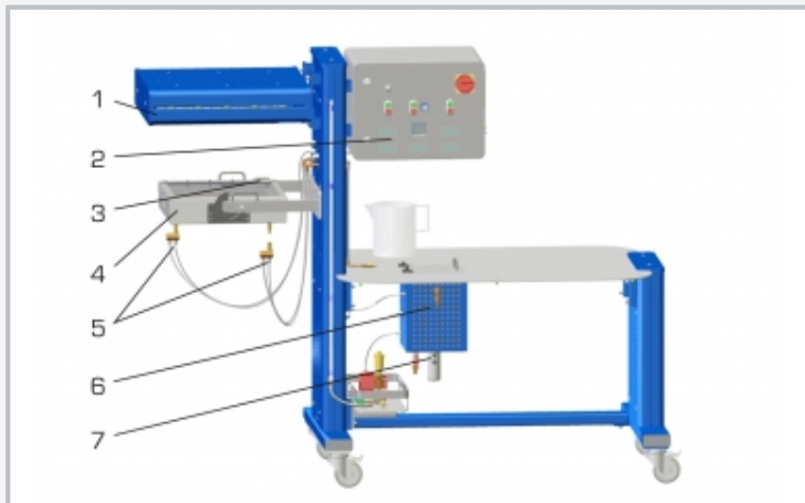
1 module d'éclairage, 2 armoire de distribution, 3 enregistreur de l'éclairement, 4 capteur solaire réglage en hauteur avec plan inclinable, 5 capteur de température, 6 réservoir, 7 chauffage électrique supplémentaire
