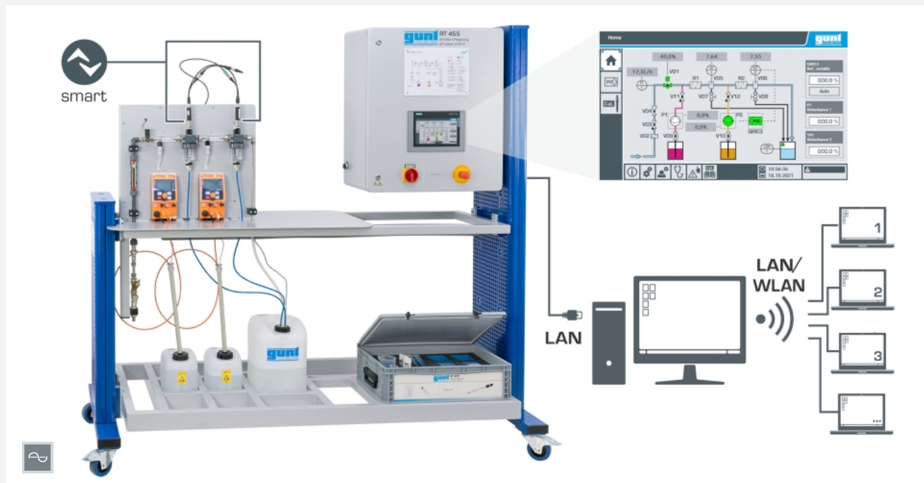
Commande et exploitation via un écran tactile ou un PC équipé du logiciel GUNT. Observation et évaluation des essais sur un nombre illimité de postes de travail via LAN/WLAN.
