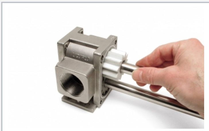
Montage der Zahnradpumpe: Antriebswelle montieren
